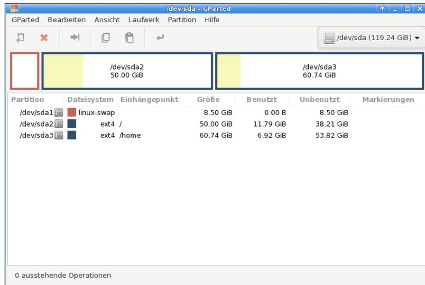
Der erste Menüpunkt **GParted** öffnet eine Drop-Down-Liste, zum erneuten Einlesen der Laufwerke, zur Auswahl eines Laufwerkes oder zum Beenden des Programms.
