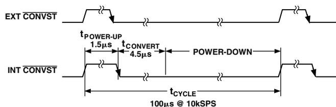
Figure 9. Automatic Power-Down
